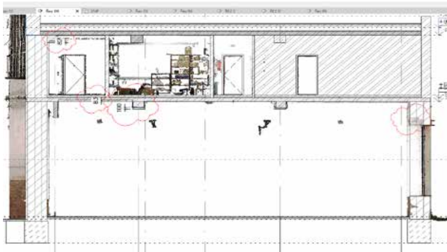
Obr. 2 Ukázka z revize projektu pasportizace průmyslové budovy v Plzni z mračna bodů. Manažer projektu při revizi v obláčcích zdůraznil velké nepřesnosti mezi umístěním prvků v informačním modelu a jejich skutečnou polohou na stavbě a vrátil model projektantovi k dopracování.
